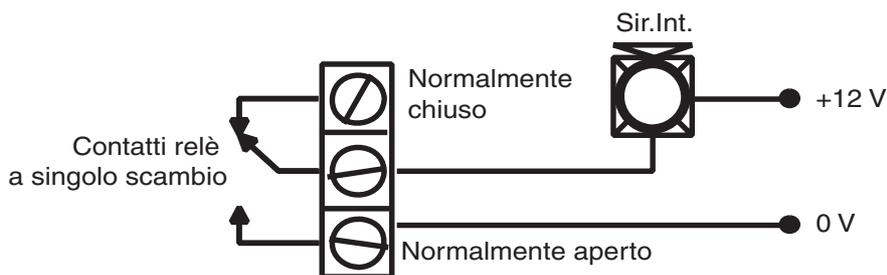
**Figura 2-16. Configurazione e applicazione tipica dell'uscita di relè a singolo scambio**
